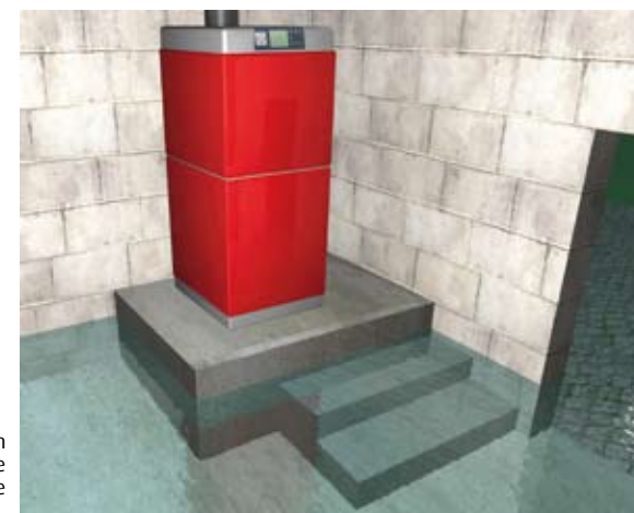
Protection d'un équipement de chauffage par surélévation.
