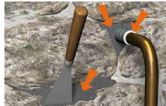
Situation après travaux : colmatage des voies d'eau.
